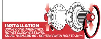
**CONE WRENCH** DRIVE SIDE: 17MM NON-DRIVE SIDE: 20MM
